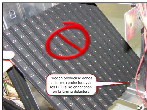
Figura 9: Extracción incorrecta del módulo desde la parte posterior
