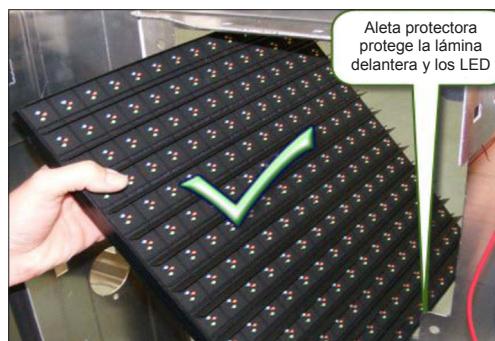
Figura 8: Extracción correcta del módulo desde la parte posterior
